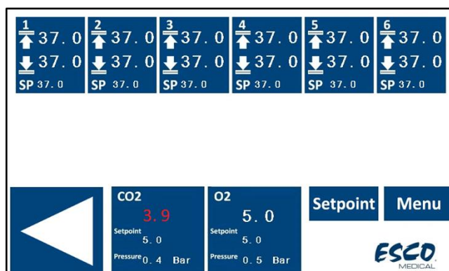
Figura 14.5 Vizualizarea alarmei privind concentrația scăzută de CO 2 pe afișajul principal în incubatorul FIV cu camere multiple MIRI® TL6
