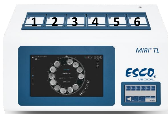
Figura 7.1 Numerele camerelor pe incubatorul FIV cu camere multiple MIRI® TL6
