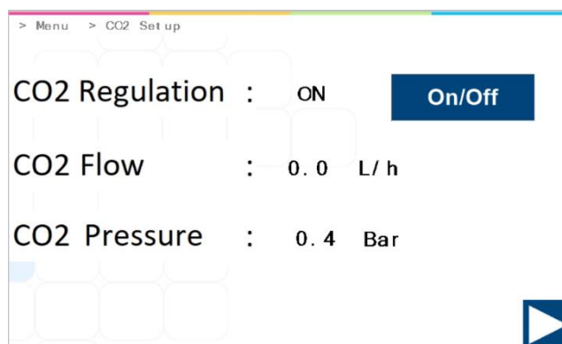
Figura 13.25 Vizualizarea submeniului de configurare CO 2 al incubatorului FIV cu camere multiple MIRI® TL6 și MIRI® TL12
