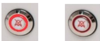
Figura 14.11 Butonul de alarmă care indică alarma
